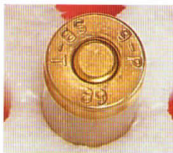
Culote de las vainas que montan la balas modelo 1 y modelo 2 (plomo y teflón).
